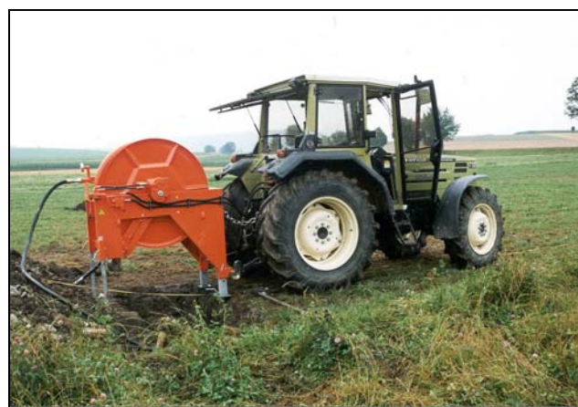
Der Geländehaspel im Einsatz
