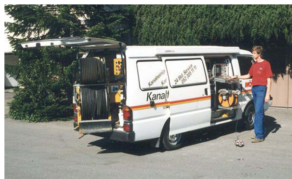
Durch die einzigartige Kombination von Spül- und TV-Fahrzeug kann sehr kostengünstig gearbeitet werden.
